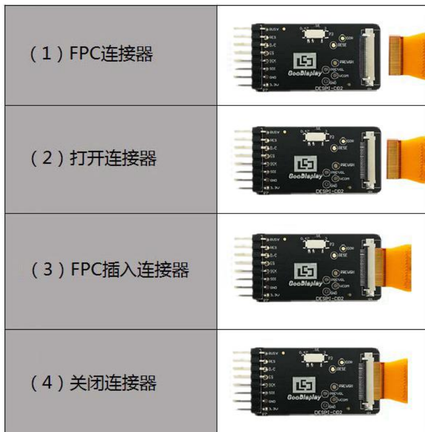
图 4 电子纸与转接板连接方式
